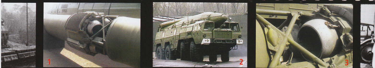
1. Raketa 9M76 – detail spojení 1. a 2. stupně 2. Odpalovací zařízení 9P120 systému Temp-S na nádvoří kasáren v Hranicích n/Moravě 3. Raketa 9M76 - detail trysky 2. stupně
